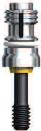
Figure 12. Piliers extensibles: comme le vis – pilier est serré, les quarts “ailes” du collier du pilier s’étendent et impliquent les prothèses avoisinantes en les sécurisant aux implants.
