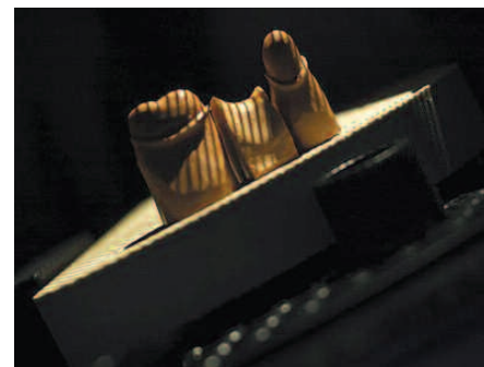
Figure 2. Projection de bandes de motifs sur un modèle.
